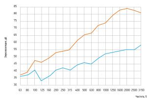
Звукоизоляция кирпичной стены 120 мм
